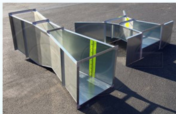
شکل ۴-۲- فلوم جهت اندازه‌گیری جریان
