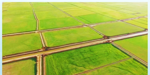
شکل ۳-۸- نمونه‌ای از کاربرد زهکش‌های سطحی و یکپارچه‌سازی اراضی
