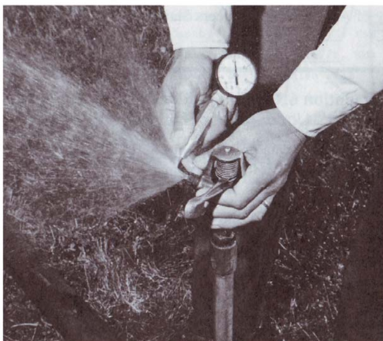
شکل ۶,۲ / اندازه گیری فشار نازل آبیاش.
