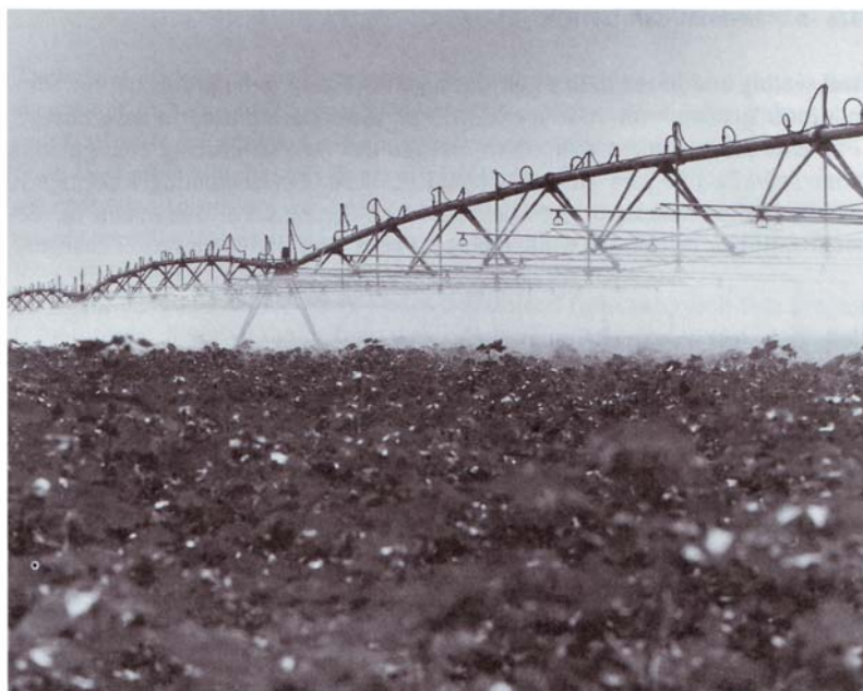
شکل ۱۴,۵ / لاترال عقربه ای با آبپاش های اسپری کم فشار که بر روی بازوهای کوتاهی نصب شده اند.
