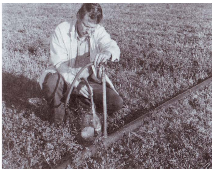
شکل ۶,۳ / اندازه گیری دبی آبیاش با استفاده از شلنگی که آب خروجی از آبیاش را به درون ظرفی با حجم مشخص منحرف می سازد.
